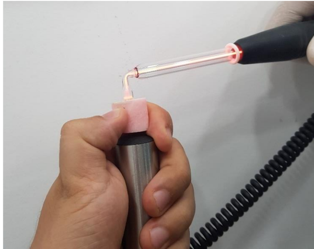
Resim 1 Soğuk plazma cihazı ve örnekler üzerine uygulanması
